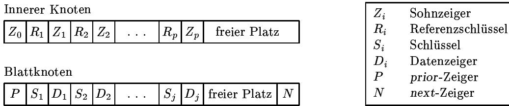
Abbildung 2.1: Knotenformate im B*-Baum mit p \in [k + 1 \dots 2k + 1] und j \in [k^* \dots 2k^*] (aus [HR99])
