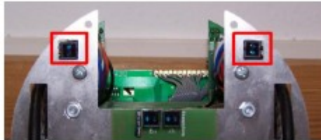
Abbildung 13: Position der Abgrundsensoren
