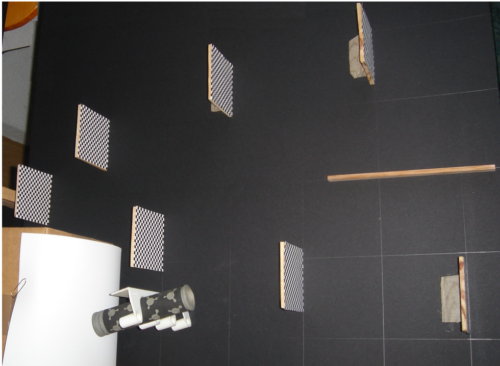
Abbildung 4.7: Blick von oben auf den Aufbau der Messkarten für die Bestimmung der Tiefenauflösung \Delta z
