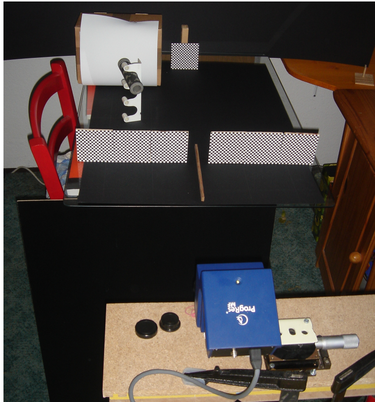
Abbildung 4.2: Aufbau des Distorsionstests: Im Vordergrund ist die Kamera auf dem Translationsschlitten zu sehen. Dahinter sind die Messkarten, die weiße Fläche zur Helligkeitskorrektur und der als Schwarzreferenz dienende Zylinder zu erkennen.
