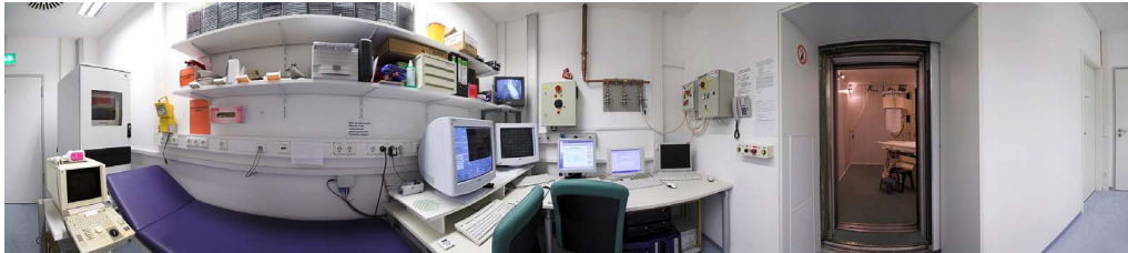
Abbildung 2.11: Ansicht des Messsystems Argos 200, von links beginnend ein Computerkabinett, ein Ultraschallgerät, eine Patiententischfläche, die Steuercomputer, dann die Überwachungscomputer, die pneumatische Schiebetür als Zugang zum magnetisch geschirmten Raum, dem Kryostat und dem Patientenbett.
