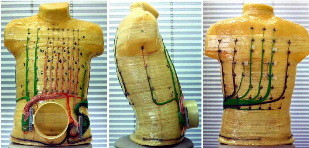
Abbildung 2.2: Das Torsophantom mit den 138 Ag/AgCl-Elektroden, wovon jede einzelne mit grauem Kunstharz verklebt ist. Im Bauchbereich befindet sich die Öffnung zum Befüllen und zum Einsetzen von Kompartimenten und von künstlichen Dipolquellen.
