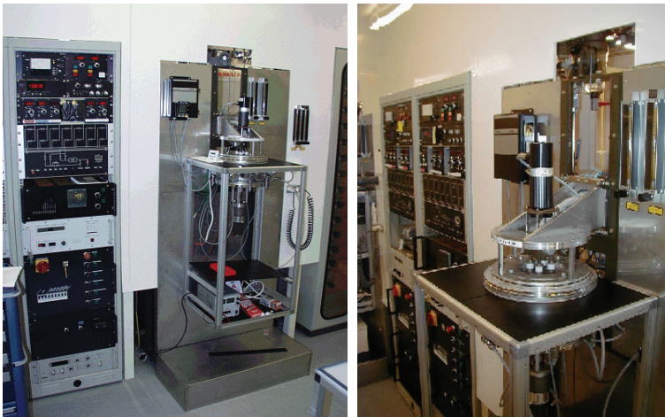
Abb. 8.2: (Links) Versuchsreaktor für die Heteroepitaxie von SiC auf Siliziumsubstraten; (rechts) Foto des LPCVD-Reaktors sowie dem Kontrollpaneel [Möl.99].
