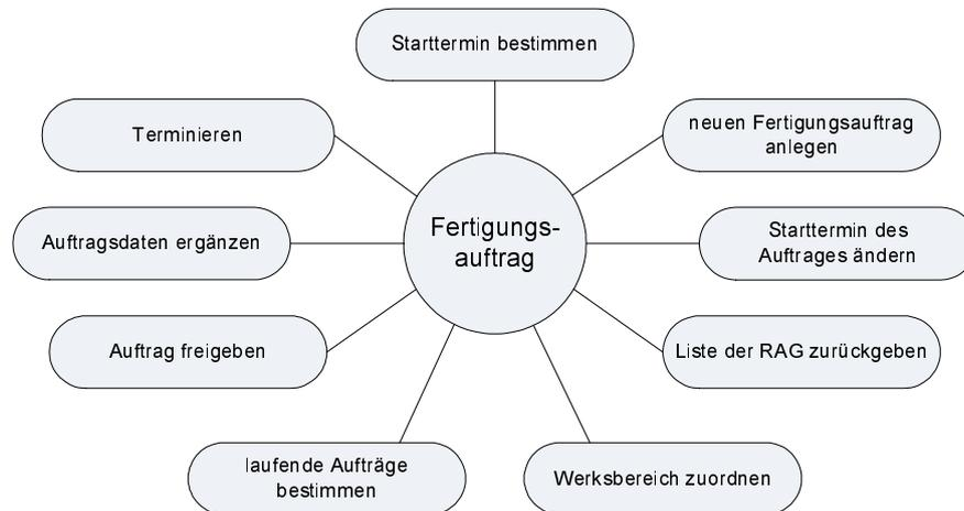
**Abbildung 5.23.:** Der Fertigungsauftrag nach der ersten Gruppierung
