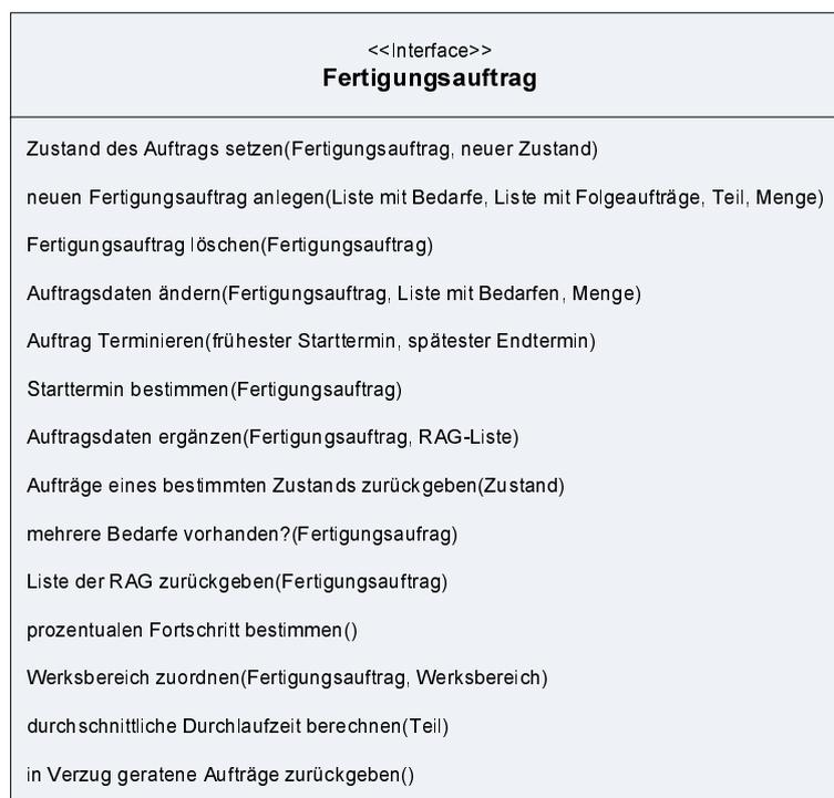
**Abbildung 5.33.:** Das UML-Diagramm der Schnittstelle des Fertigungsauftrages
