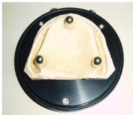
Abb. 52: Modell mit integrierten Referenzpunkten
