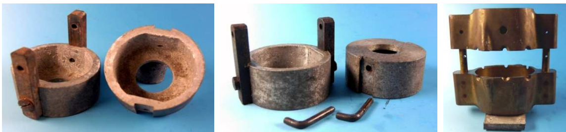
Abb. 4-6: Küvettenformen für die Kunststoffkronen – und Brückentechnik
