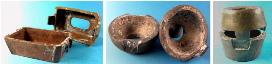
Abb. 1-3: Küvettenformen für die Kunststoffkronen – und Brückentechnik
