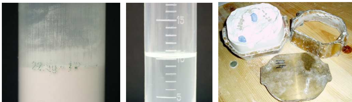
Abb. 76 - 78: Mischungsverhältnis Kunststoff / Pulver und schrittweise Ausbettung der Prothese
