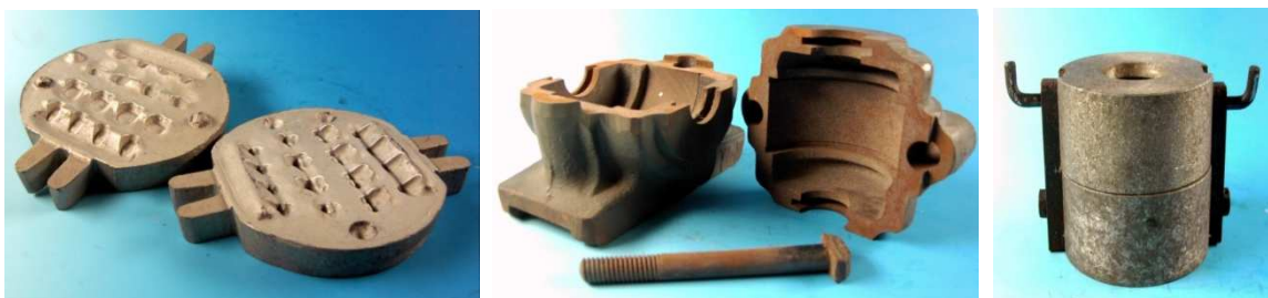
Abb. 7-9: Küvettenformen für die Kunststoffkronen – und Brückentechnik
