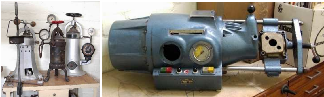
Abb. 17 - 18: Vulkanisatoren und Spritzgussanlage (aufgenommen in der Zahntechnik Stemmann Hamburg Aug.2006)
