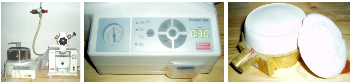
Abb. 68 - 70: Geräteanordnung, Polymerisationsvorgang und schrittweise Ausbettung der Kuvetten
