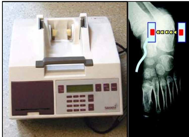
Abbildung 9a,b: Sahara-Bone-Densitometer und schematische Darstellung der Messstrecke 5
