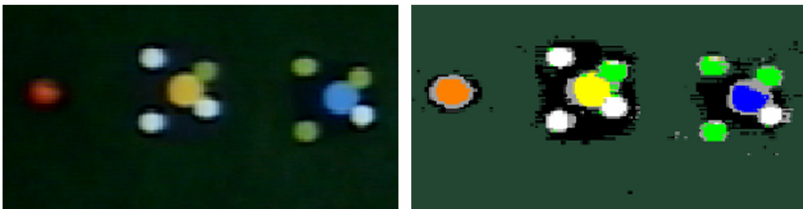
Abb. 4.5 Ausschnitt Live-Bild (links) und zugehörendes klassifiziertes Bild (rechts)
