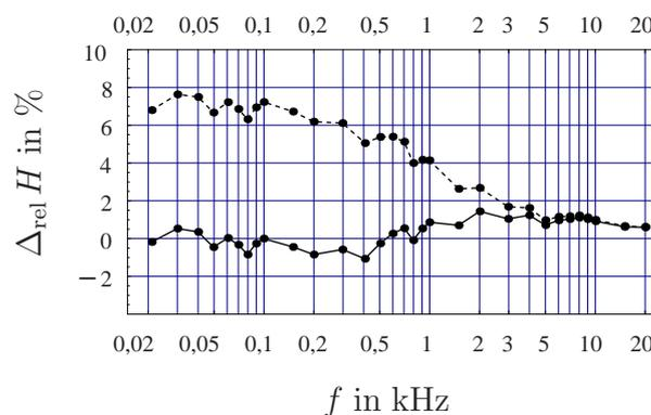
Abb. 2: Darstellung der relativen auf die Messung bezogene Abweichung des Betrages  $|H(\omega)|$  bei idealem RC- Hochpass (- - -) und fraktionalem Hochpass (—)
