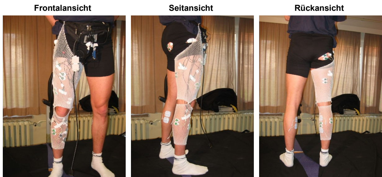
Abb. 12: Abgeschlossene Vorbereitungsmaßnahmen für elektromyografische Messungen
