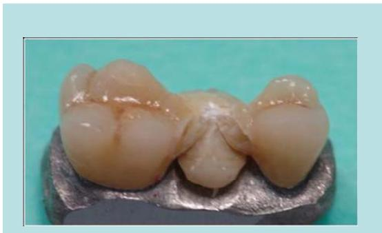
Abb.23: Fotografie der Fraktur einer Brücke kleiner Spannweite aus Empress 2<sup>®</sup>
