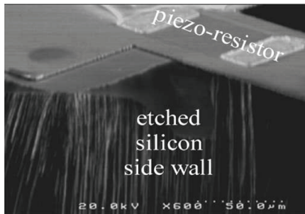
Abb. 3: AlGaIn/GaN-Cantilever auf Silizium, an dessen Pivotpunkt ein 2DEG-basierter Piezo-resistor realisiert wurde [Zim06].
