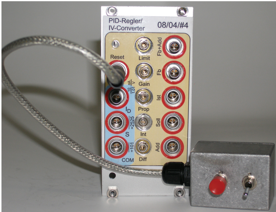
Abbildung 5.10.: Der PID-Regler wurde mit der zur Ansteuerung des SETs benötigten Strom-Spannungs-Wandler-Schaltung in ein gemeinsames Gehäuse verbaut. Durch die Herausführung aller Ausgänge zur Frontseite ist jedoch auch ein separater Betrieb der beiden Einzelschaltungen möglich. Ebenso sind Einstellmöglichkeiten zur unterschiedlichen Gewichtung von Proportional-, Integral- und Differentialglied sowie der Gesamtverstärkung der Regelschaltung und zur Begrenzung der maximalen Ausgangsspannung vorhanden.
