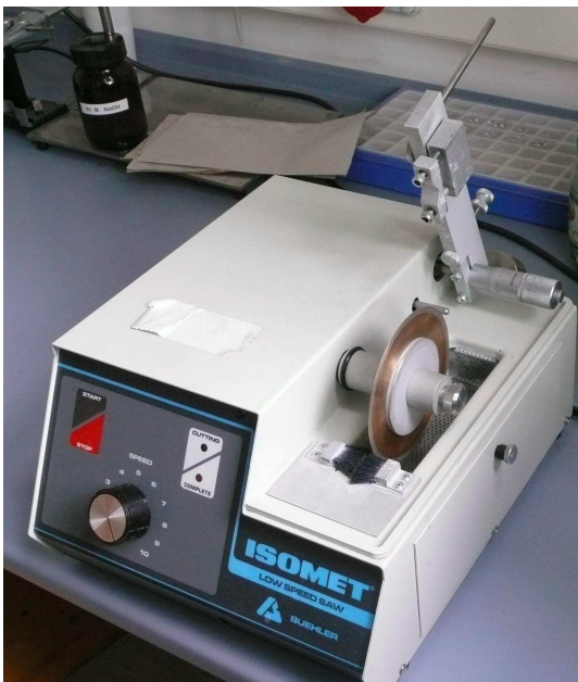
Abb. 11: Diamantsäge Isomet low speed saw der Firma Buehler, Institut für Materialwissenschaft und Werkstofftechnologie, FSU Jena, Foto: Katrin Flemming.
