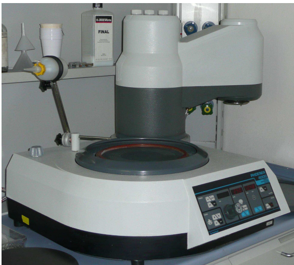
Abb. 14: Poliermaschine Phoenix 4000 der Firma Buehler, Institut für Materialwissenschaft und Werkstofftechnologie, FSU Jena, Foto: Katrin Flemming.
