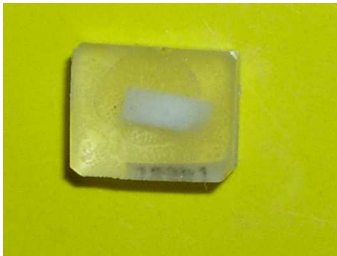
Abb. 13: Eingebettete Milchzahnprobe, fertig zur Politur, Foto: Katrin Flemming.
