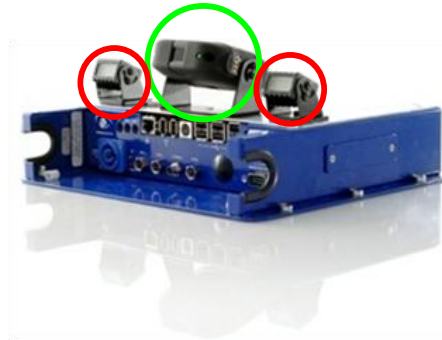
Abbildung 3.10: Das DSS Systems bestehend aus zwei IR-Beleuchtungsmodulen (links & rechts, rot hervorgehoben), einer IR-Kamera (Mitte, grün hervorgehoben) und einem embedded Car PC (unten), (Seeing Machines, 2008)
