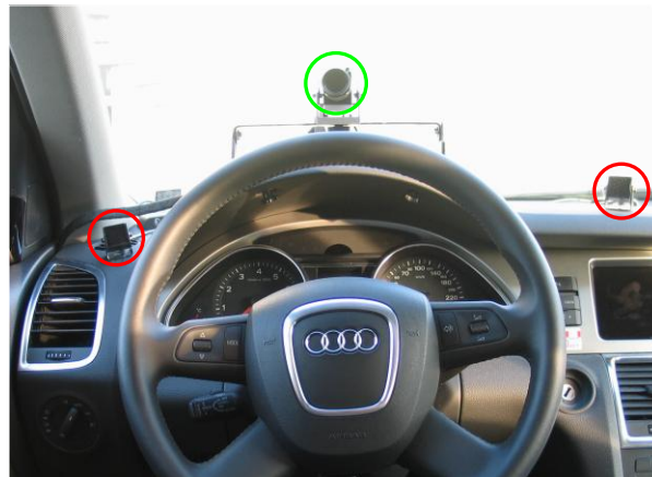
Abbildung 4.1: Anordnung des DSS Systems, mittig vor dem Fahrer die Kamera (grün) sowie die 2 IR-Beleuchtungsmodule (rot) links und rechts
