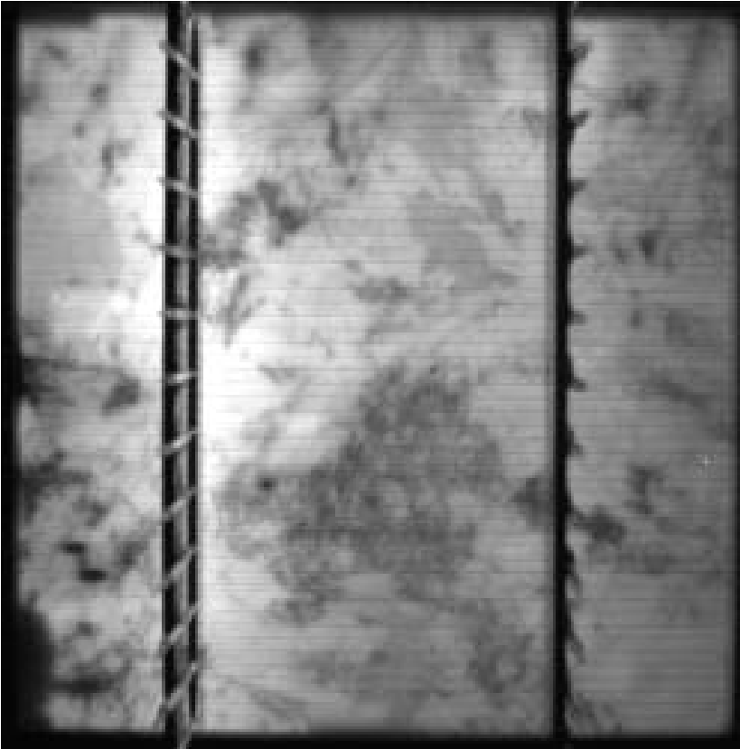
Abbildung 3.12: Elektrolumineszenz-Bild einer multikristallinen Silizium-Solarzelle. Die Helligkeitsunterschiede geben die Verteilung der Überschussladungsträgerdichte wieder.
