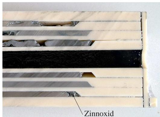
**Abbildung 6.6.** – Axialschnitt durch einen Fixpunktstrahler der Variante 2
