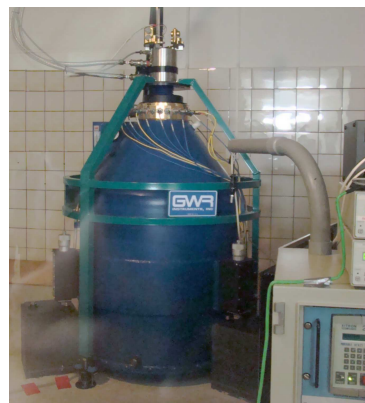
Abbildung 1.2: Das supraleitende Gravimeter CD-034. (Foto: W. Kühnel)
