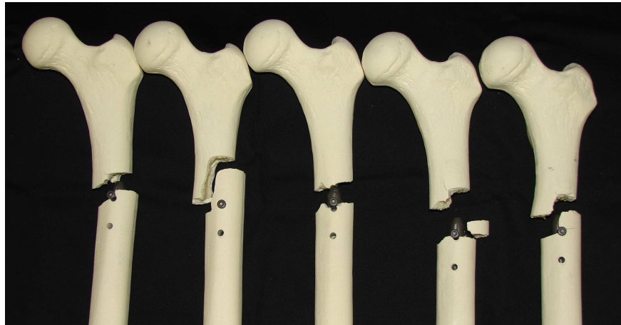
Abb. 6: Versagen FCS-Kunstknochen mit T2 im axialen Test
