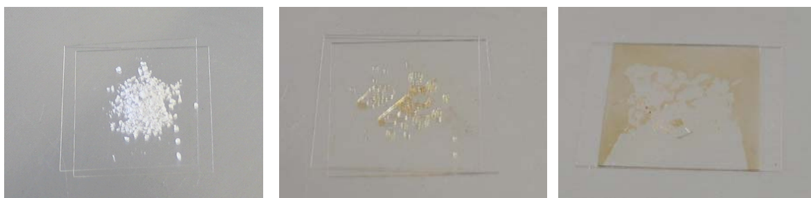
Abbildung 3.32. Schmelzprozess einer hochsubstituierten TMSC (DS 2,89) bei 273°C
