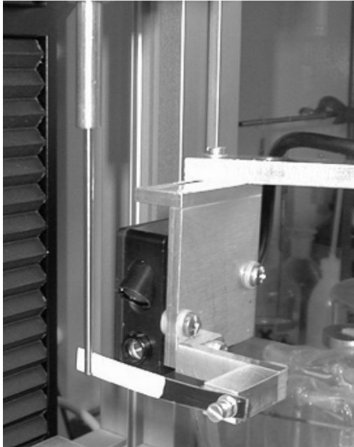
Abbildung 28: Messung des Taumelfehlers des Substratstabes durch Messung des Abstandes des Substratstabes zum Meßkopf während Rotation des Substratstabes, die Abstandsbestimmung erfolgt in einem Meßbereich von 2 mm mittels Triangulationsmeßverfahren bei einer Auflösung von 1 \mu\text{m}
