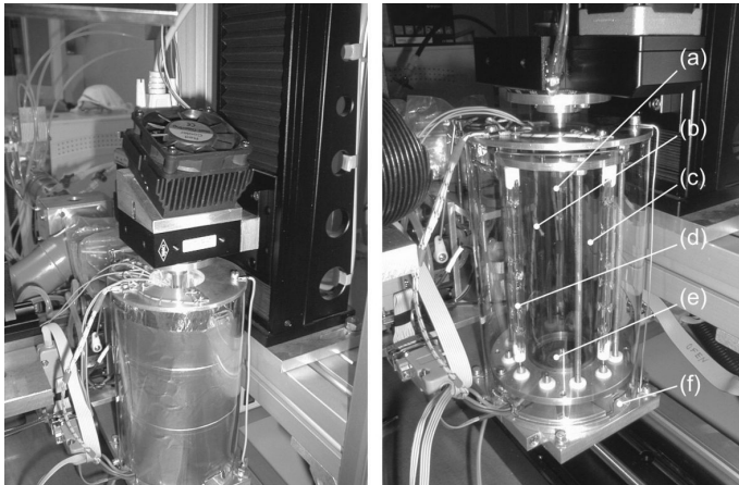
Abbildung 30: Baugruppe zum Tempern von Silikonelastomer- und Fotoresistschichten, Darstellung des Temperofens mit eingefahrenem Substratstab im laufenden Betrieb (links) und Darstellung ohne Reflektorschild mit eingefahrenem Substratstab (rechts): (a) Substratstab mit Temperatursensoren für Vergleichsmessungen, (b) Kontaktelement zur Messung der Ofentemperatur, (c) innere Ofenröhre aus optischem Filterglas, Begrenzung des nutzbaren Ofenvolumens, (d) Halogenröhre als Heizelement, (e) Miniaturlüfter zur Erzeugung eines konstanten Luftstromes, bessere Regelbarkeit des Ofens im unteren Temperaturbereich
