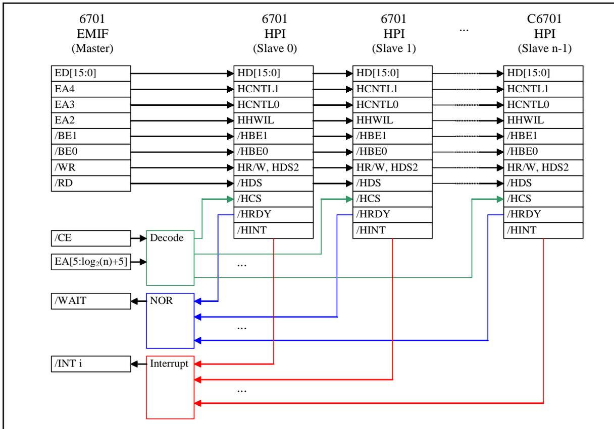
Abb. 2: Verknüpfung von Steuersignalen für den broadcastfähigen Bus
