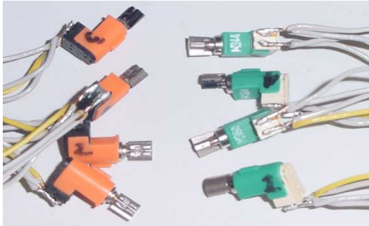
Abb. 1: Unwuchtmotoren für Handys
