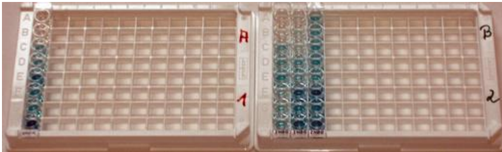
Abb. 16: Mikrotiterplatten für den Influenzavirus A- bzw. B-IgG-ELISA, Kontrollen (A1, B1, C1, D1, E1) und Proben (Influenzavirus A-Nachweis: F1, G1, H1, Influenzavirus B-Nachweis: F1-H3) bestückt mit TMB-Substratlösung (Blaufärbung).
