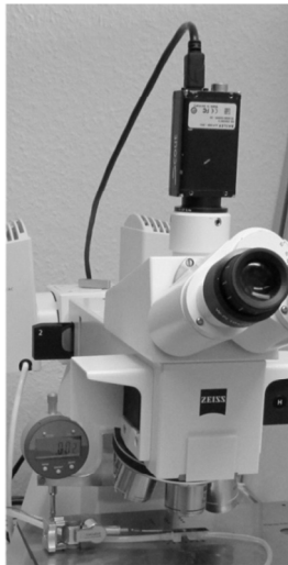
Abbildung 40: „Ortsfeste“ Konfiguration der CCD-Kamera und des Manipulators am Mikroskop
