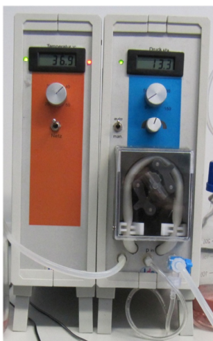
Abbildung 24: Versorgungseinheit bestehend aus druckgeregelter Schlauchpumpe und Temperaturregelung mit Temperatur- und Druckanzeige
