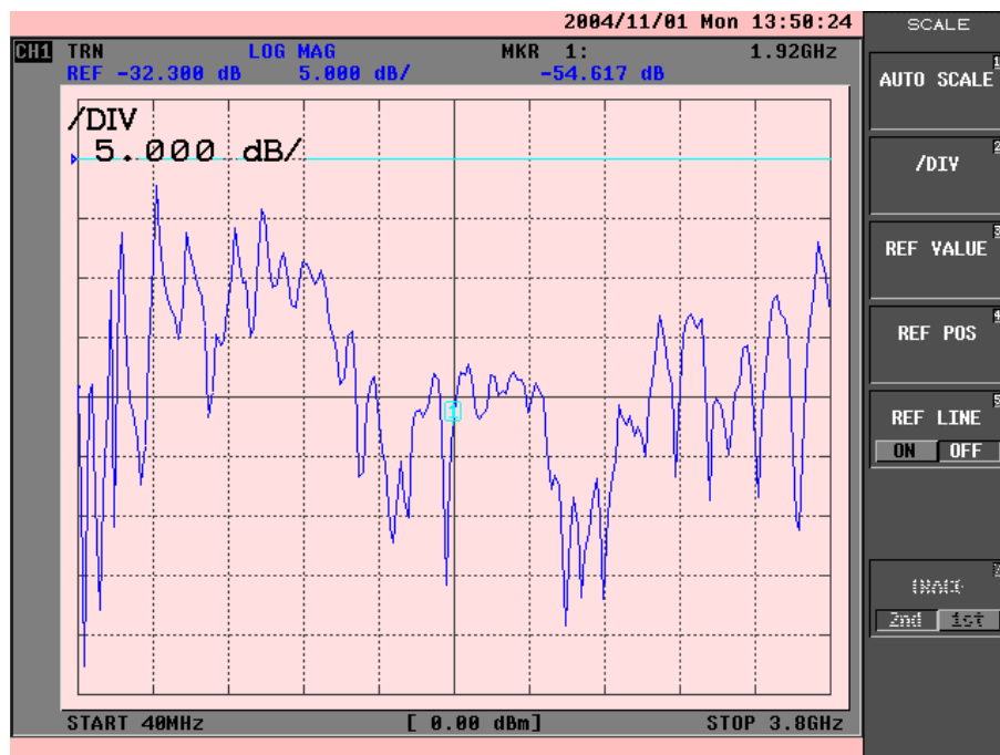
Bild 4: Schirmdämpfung der unbeschichteten HF Koaxleitung RG58 mit Kupferstripline
