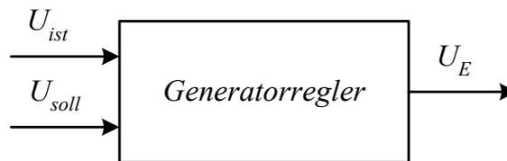
Abbildung 6.24 Blockschaltbild des Generatorreglers mit den Eingangsgrößen der aktuellen Generatorspannung  $U_{ist}$  und der vorgegebenen Sollspannung  $U_{soll}$  sowie der Erregerspannung  $U_E$  als Ausgangsgröße.
