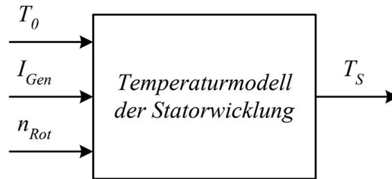
Abbildung 6.5 Blockschaltbild der Statorwicklung mit den Eingangsgrößen Umgebungstemperatur  $T_U$ , Generatorstrom  $I_{Gen}$  und Rotordrehzahl  $n_{Rot}$  sowie der Temperatur der Statorwicklung  $T_S$  als Ausgangsgröße.
