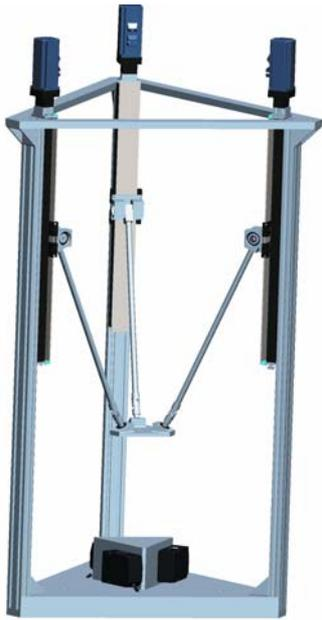
**Bild 1: Paralleler Mechanismus Tripod**
