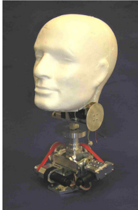
Abbildung 2: Halsgelenk mit vier Freiheitsgraden
