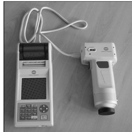
Abbildung 3: Chroma-Meter zur Messung des Verschmutzungsgrades einer Felge
