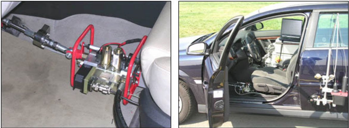
Abbildung 10: Betätigungsautomatik für Pedale
