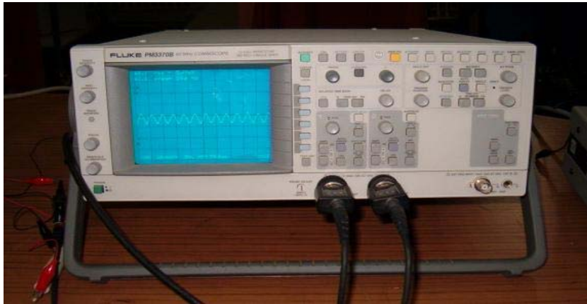
Abb.3 Überprüfung mittels des Oszilloscop der Vibrationsplatte und dem Bechleunigungsgeber
