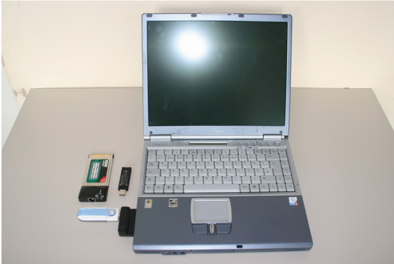
Abbildung F.2: Als mobiles Endgerät kam dieser Laptop zum Einsatz. Er konnte mit zwei Ethernetschnittstellen, zwei WLAN-Adapttern und einem Bluetooth-Adapter zwecks Kopplung an ein Handy ausgestattet werden.
