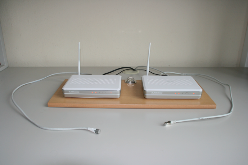
Abbildung F.7: Der Versuchsaufbau schloss diese beiden WLAN-Basisstationen, welche formschön auf einem Brett montiert worden waren, mit ein. Sie boten jeweils einen Zugang zum Internet mittels Ethernet und WLAN an.
