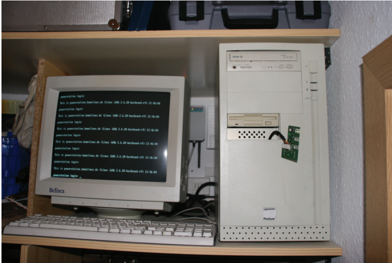
Abbildung F.6: Dieser Server stand in der Wohnung des Autors und stellte ebenfalls einen REACH-Proxyserver dar. Zudem verfügte er über eine Anbindung an das digitale Telefonnetz (ISDN).
