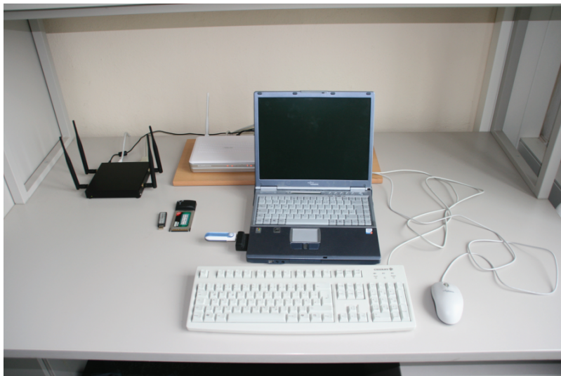
Abbildung F.1: Der Testaufbau im Büro des Autors, mit einem mobilen Endgerät, der REACH-Box und zwei WLAN-Basisstationen (teilweise verdeckt)
