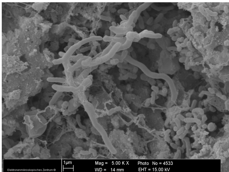
Abb. 21: REM-Aufnahme eines frischen Prüfkörpers nach der Mischkultur-Anlagerung
