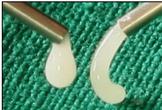
**Abb. 38:** Verhalten bei Applikation aus Kanüle nach 30 Sekunden, links Luxa Flow, rechts Artiste Nano-Hybrid Flowable Composite bei Raumtemperatur
