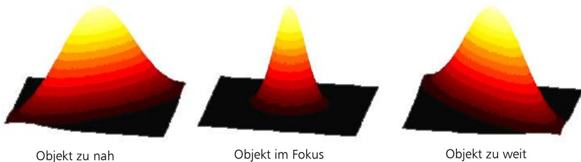
Abbildung 3.4: Intensitätsverteilungen auf der Quadrantenfotodiode
