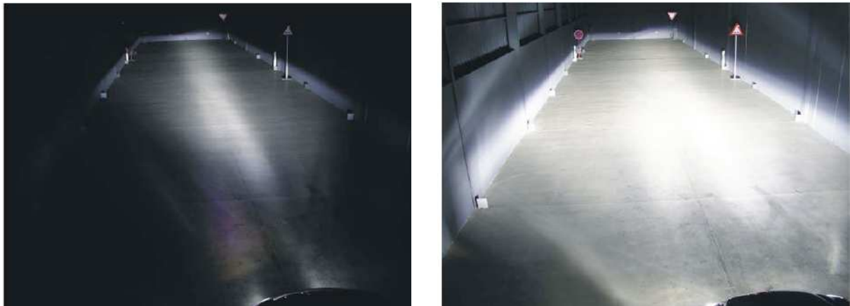
Abb. 3.1: Gesetzlich zulassungsfähige Abblendlichtverteilung und gute Lichtverteilung dargestellt in einem Lichtkanal (vgl. Kleines [Kle03])
