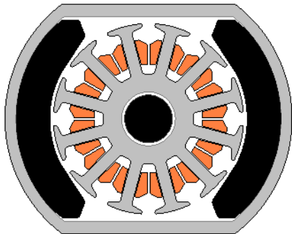
Bild 4.5 Querschnitt des betrachteten PM-DC Motors mit 12 Nuten und abgeflachtem Ständer
