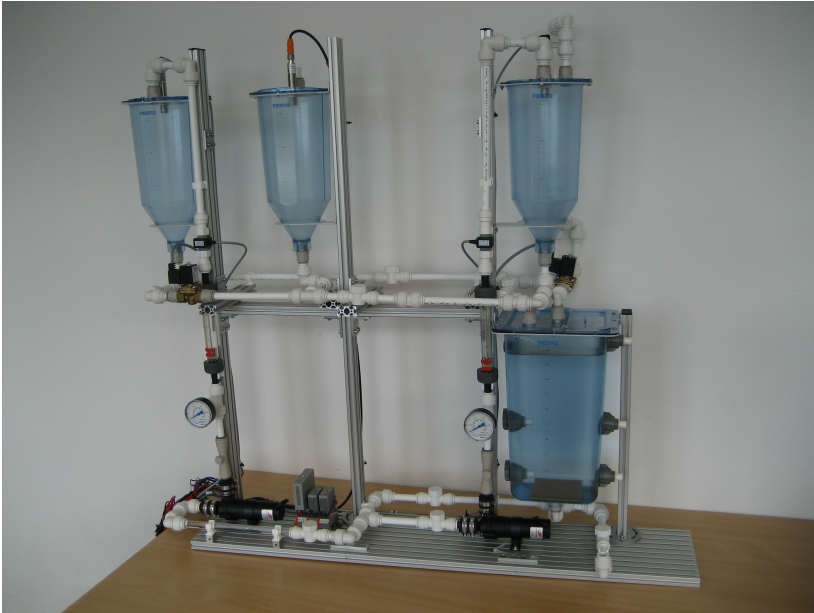
Abbildung 4.1.: Dreitanksystem des Fachgebietes Systemanalyse.
