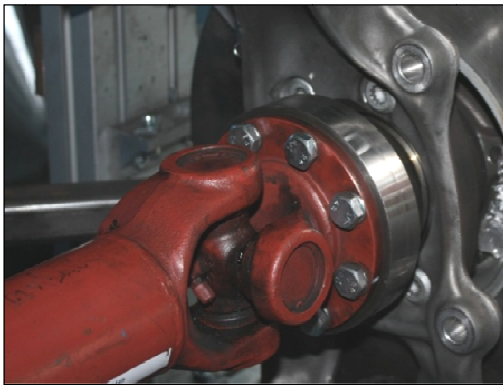
Abbildung 64: Prüfstandwellenantrieb des Prüflings über Achswellenstumpf
