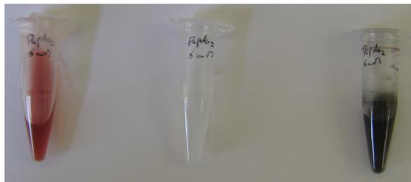
**Abb. 8:** Effekt von EDTA und  $\text{H}_2\text{S}$  auf  $\text{Fe}^{2+}$ -PDC-Komplex-Lösungen:  $\text{Fe}^{2+}$ -PDC-Komplex 6 mM in TRIS-HCl-Puffer ohne Zusätze (links), nach der Zugabe einer äquimolaren Menge an EDTA (Mitte) und nach Inkubation mit gasförmigem  $\text{H}_2\text{S}$  (rechts)
