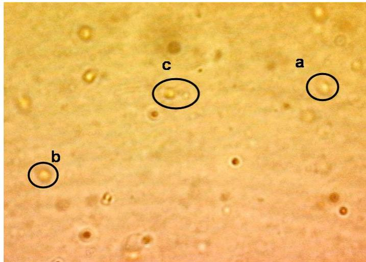
**Abb. 25:** Lichtmikroskopische Aufnahme (100-fache Vergrößerung) einer mittels GPC aufgereinigten,  $\text{Fe}^{2+}$ -haltigen Polymersomendispersion; Größe ausgewählter Vesikel:  $2\ \mu\text{m}$  (a),  $2,1\ \mu\text{m}$  (b) und  $1,7\ \mu\text{m}$  bzw.  $1,2\ \mu\text{m}$  (c)
