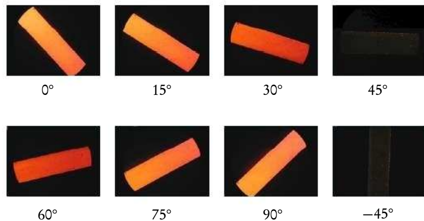
Bild 3.8: Polarisationsmikroskopie an einer mechanisch ausgerichteten Fulce-Probe [SF05b] bei unterschiedlichen Probenwinkeln für die Prüfung der Homogenität und Richtung der Ausrichtung
