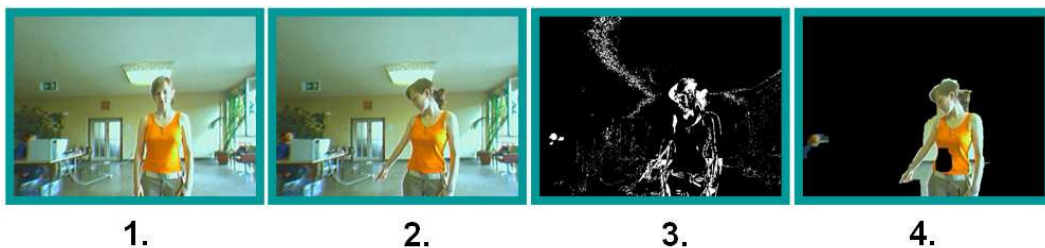
Abbildung D.4: Ablauf einer Hintergrundsubtraktion mittels Differenzbild. (1.): Bild einer Person vor einer Zeigegeste und (2.): während einer Zeigegeste. (3.): Differenzbild. Weiß markiert sind Stellen, an denen sich Bild 1 und 2 um mehr als eine festgelegte Schwelle im Grauwert unterscheiden. (4.): Durch Anwenden eines Closing- und Connected-Regions-Algorithmus entsteht aus dem Differenzbild eine Maske, die über das Eingangsbild gelegt wird und die zeigende Person extrahiert.
