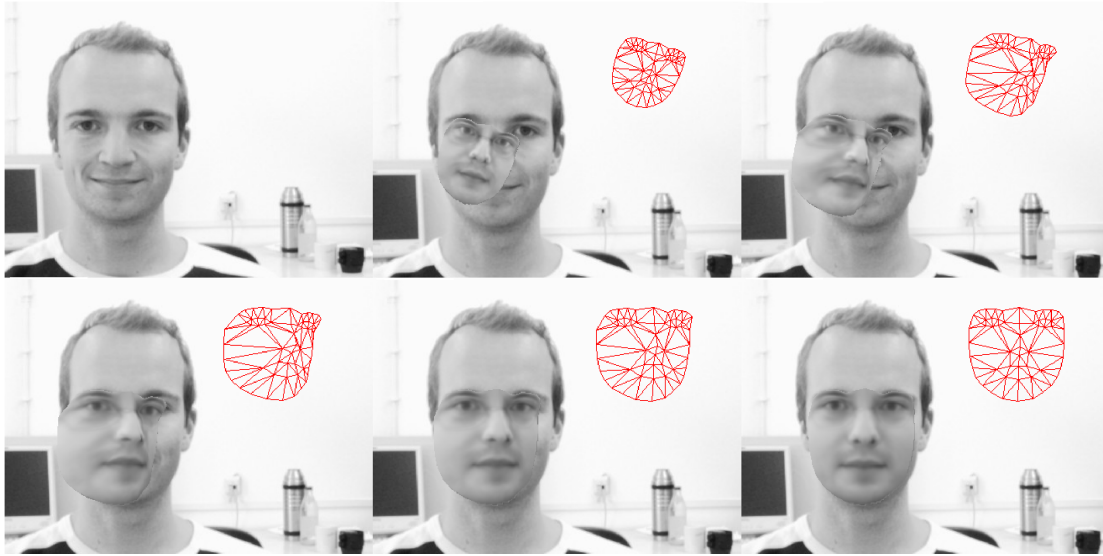
Abbildung 4.16: Iterationen des AAM Anpassungsalgorithmus. Während das erste Bild das Eingabebild zeigt, ist im zweiten zusätzlich die Modellinstanz mit der entsprechenden Initialisierung zu sehen. In den weiteren Bildern (Iteration 5, 15, 20 und 30) sind die Anpassungsschritte bis zur Konvergenz des Modells zu sehen. Quelle: [Werner, 2007]
