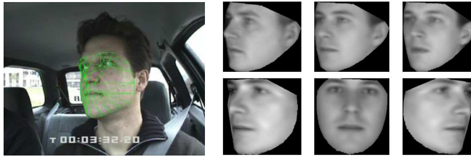
Abbildung 4.5: Beispielbilder zur Kopfposenschätzung mittels AAMs. Links: Ein Bild eines Fahrers mit angepassten Modell aus [Baker et al., 2004]. Rechts: Abdeckungsbereich zweier Modelle aus [Cootes et al., 2000].
