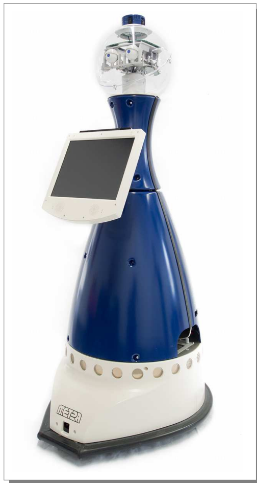
Abbildung 6.2: Das für die Integrationsexperimente eingesetzte Robotersystem ALIAS - basierend auf der SCITOS Roboterplattform der Firma MetraLabs .
