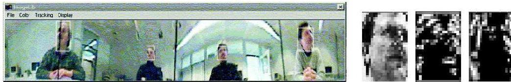
Abbildung 4.3: Links: Aufnahme der Omnikamera aus einer Konferenz. Die Gesichter wurden bereits detektiert und markiert. Anschließend wird die Blickrichtung der Personen ermittelt, um den gerade sprechenden Konferenzteilnehmer zu ermitteln. Dieser wird von den übrigen Personen angeschaut. Rechts: Eingabedaten für das neuronale Netz (extrahiertes Gesicht plus zugehörige horizontale und vertikale Kantenbilder).
