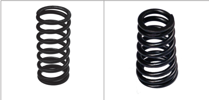
Bild 4.14 Bilder der zylindrischen und der konischen Feder, mit der die meisten Versuche durchgeführt wurden
