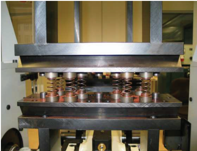
Bild 2.4 Vertikal schwingende Prüfmaschine für Lastwechseltests der Fa. IABG München
