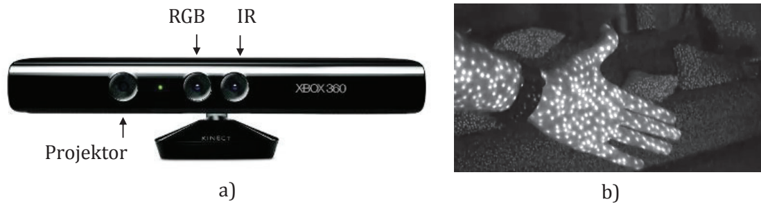
Abbildung 2.2: Kinect-Sensorleiste [LTD, 2013] und Infrarotmuster [STANFORD, 2013]
