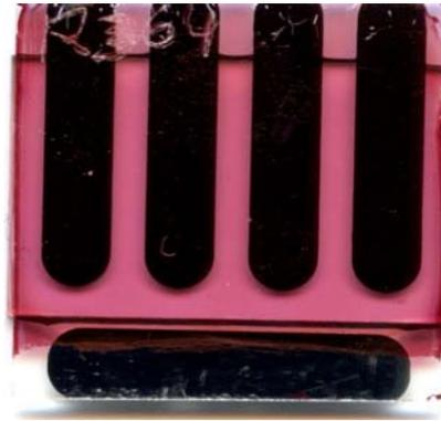
**Abbildung 3.3: Durch das ITO-Glas aufgenommenes Foto einer in Eigenarbeit prozessierten Polymersolarzelle mit vier Solarzellen mit je  $0,5 \text{ cm}^2$  aktiver Fläche auf einem 1 Zoll x 1 Zoll großen Substrat.**
