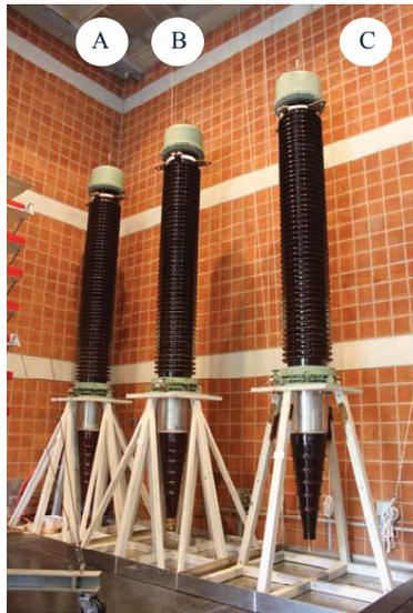
Bild 3.2-1: 400 kV-Hochspannungstransformatordurchführungen, Prüflinge A, B und C
