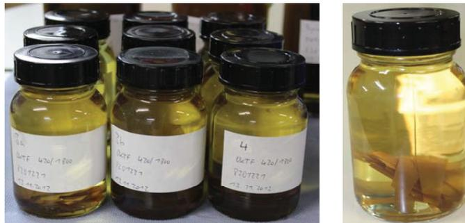
Bild 6.2-3: Konservierung der von Prüfling C entnommenen Papierstreifen in Originalöl
