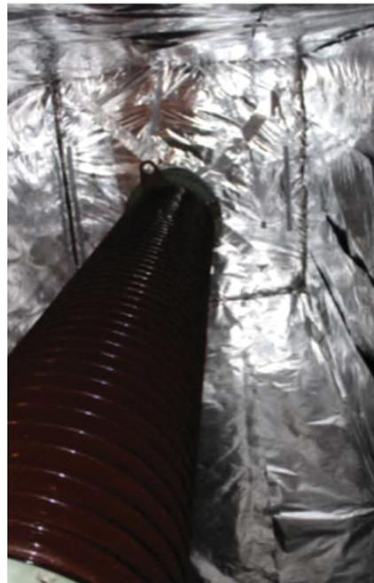
Bild 4.6-7: Thermische Isolierung mit eingebrachtem Schirm aus geerdeter Aluminiumfolie; links: Blick von oben mit geöffnetem Deckel, rechts: Blick von unten mit geschlossenem Deckel
