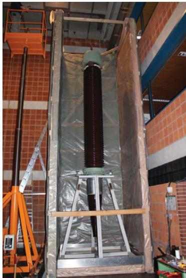
Bild A-1: Thermische Isolierung einer 400 kV-OIP-Durchführung während des Aufbaus
