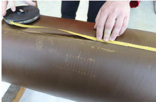
Bild 6.2-2: Entnahme von Papierstreifen aus dem Wickel von Prüfling C
