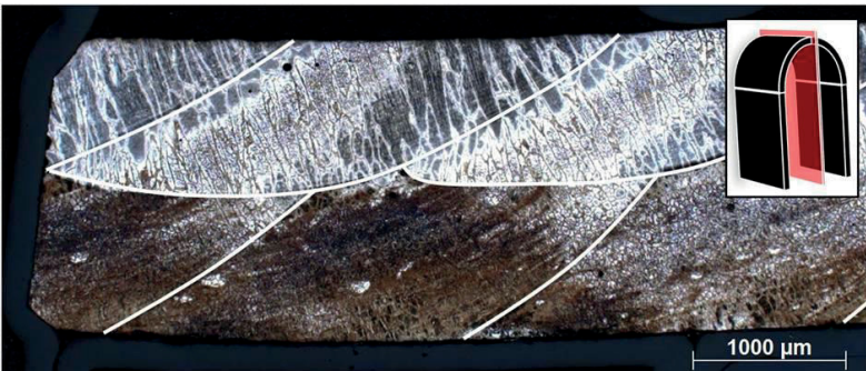
Abbildung 75: Querschliff einer 2-lagigen SpRK-Probe mit Aufwölbung am Randbereich (links), Werkstoff X2CrNiMoN22-5-3; Einzelne Spuren und Grobkornbereiche deutlich erkennbar
