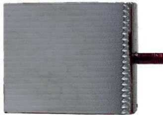
Abbildung 71: Makroaufnahme gefrästen und elektropolierten Probe
