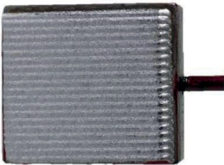
Abbildung 70: Makroaufnahme der nach dem Schweißen elektropolierten Probe
