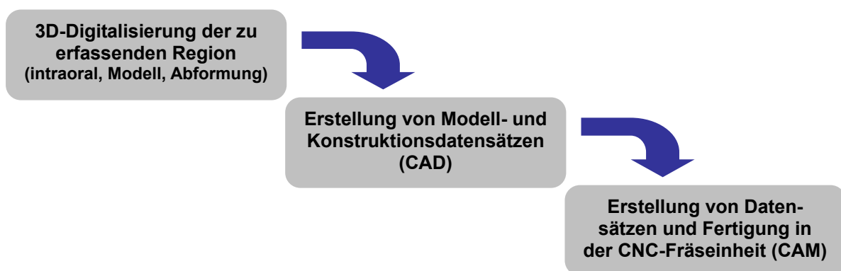
Abb. 27: CAD/CAM Herstellungsprozess, modifiziert nach QUAAS et al. 2008
