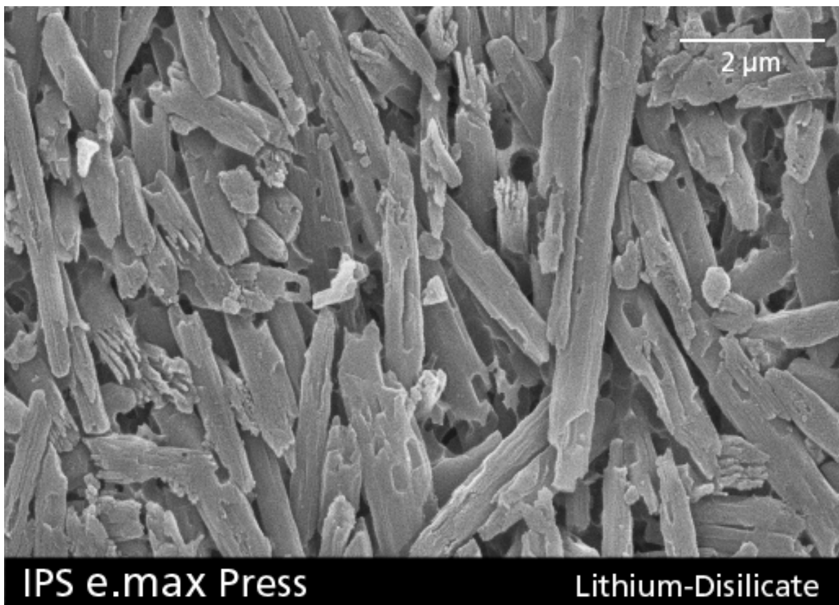
Abb. 2: Gefüge der Lithiumdisilikat-Keramik IPS e.max Press in REM, geätzt in HF-Dampf 30 s (Foto: Ivoclar Vivadent)
